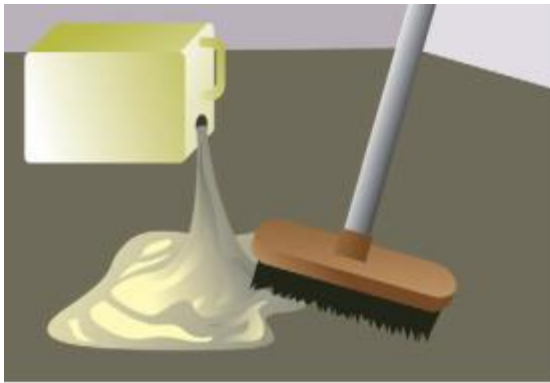
Рис. 28. Нанесення шару ґрунтовки Рис. 29. Визначення горизонтальності основи
