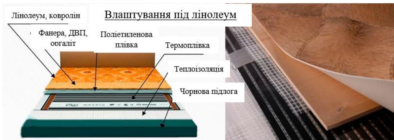
Рис. 45. Конструкція підлоги з лінолеумом
