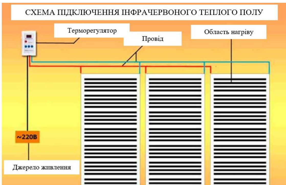
Рис. 43. Схема підключення інфрачервоного теплого полу
