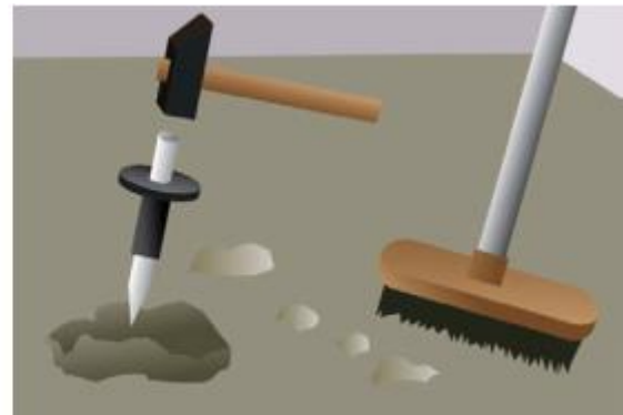
Рис. 22. Визначення міцності стяжки Рис.23. Видалення неміцних ділянок поверхні основи
