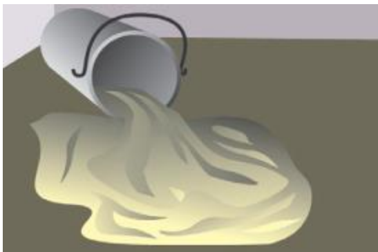
Рис. 31. Нанесення розчинової суміші Рис.32. Розподіл розчинової суміші на поверхню
