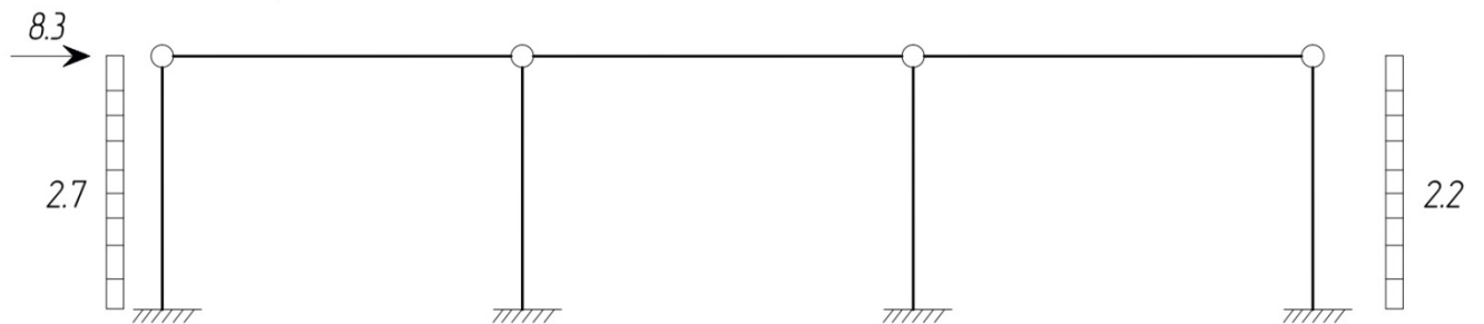
Рис. 4.7. Схеми завантаження рами для статичного розрахунку за експлуатаційними (2 група граничних станів) навантаженнями
