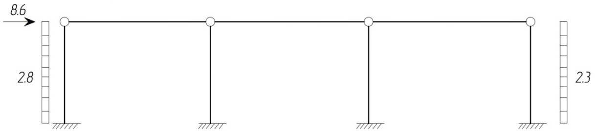
Рис. 4.6. Схеми завантаження рами для статичного розрахунку за граничними (1 група граничних станів) навантаженнями
