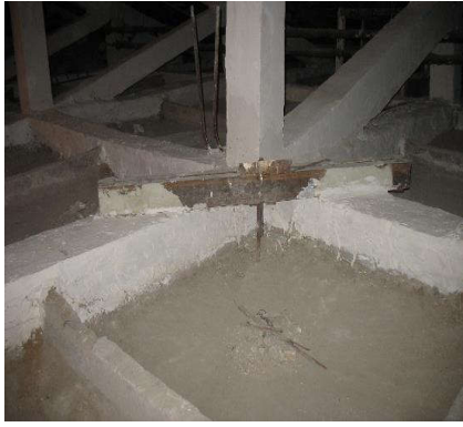
Рис. 1. Створення навантаження Просвердлені отвори в перекритті. Сталеві тяжі для підвіски вантажів
