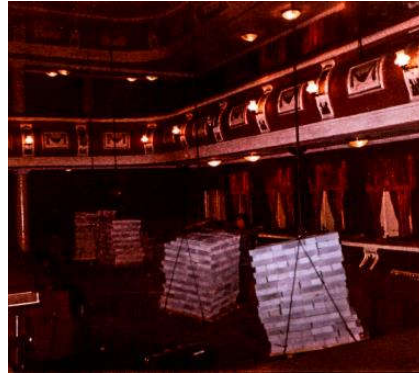
Рис. 1. Створення навантаження Просвердлені отвори в перекритті. Сталеві тяжі для підвіски вантажів
