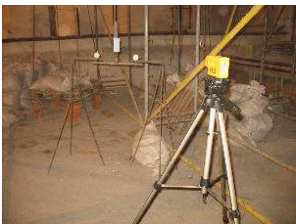
Фото 3.7. Визначення прогинів за допомогою лазерного інтерферометра
