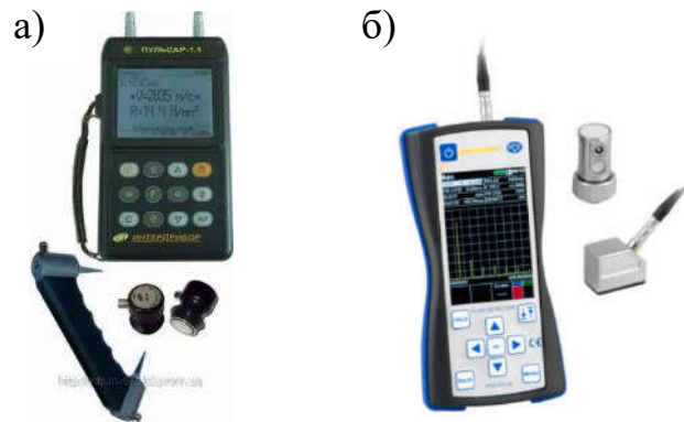
Фото. 2.10. Ультразвукові дефектоскопи: а) ПУЛЬСАР-1.1; б) PCE-FD20
