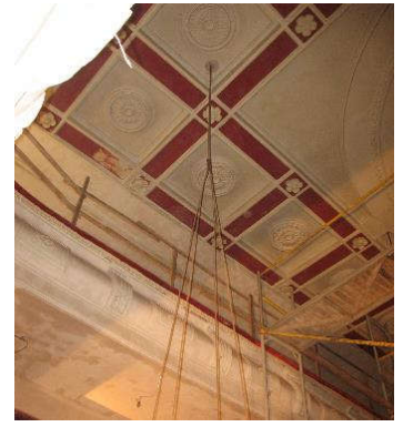
Рис. 1. Створення навантаження Просвердлені отвори в перекритті. Сталеві тяжі для підвіски вантажів
