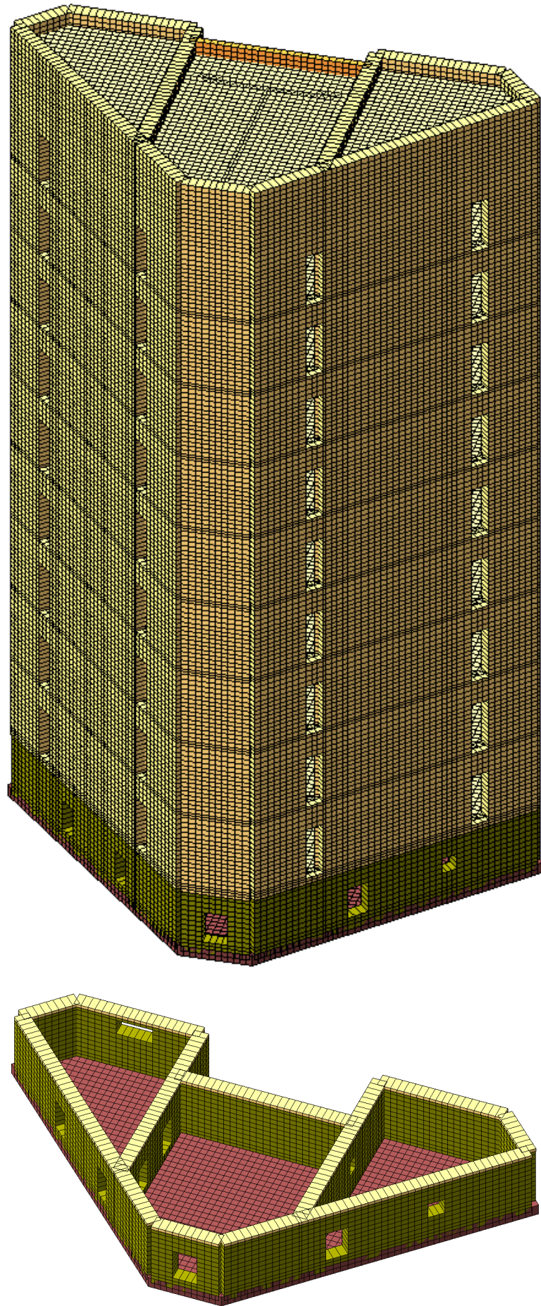
Рис. 3.4. Розрахункова скінченно-елементна модель вставки (двір)
