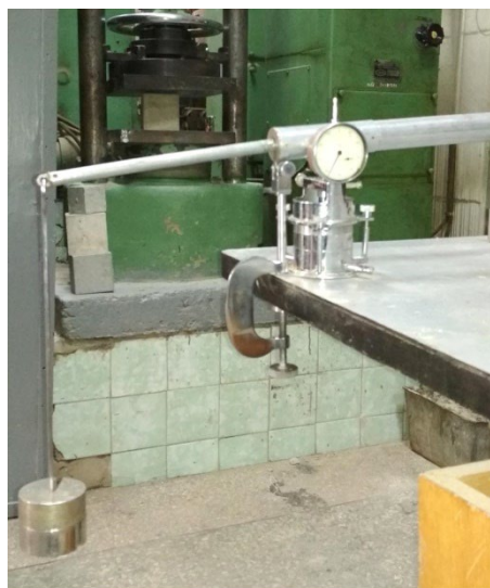
Рис.3.12. Випробування ґрунтів (метод компресійного стиску)
