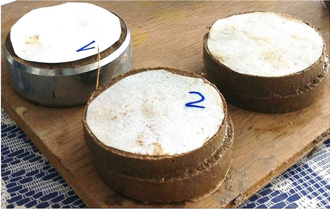
Рис. 3.9. Ґрунтові зразки (природній вигляд) опісля проведення випробувань (одноплщинний зріз)
