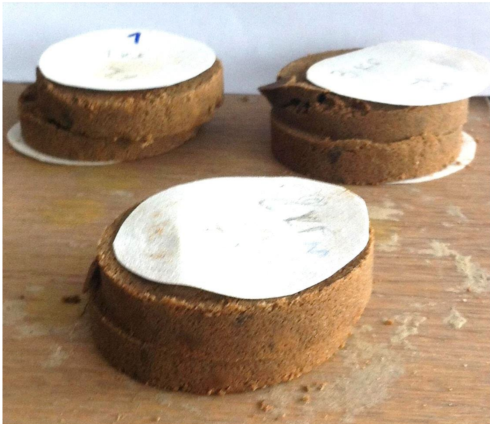
Рис. 3.10. Ґрунтові зразки (підсиленний ґрунт) опісля проведення випробувань (одноплщинний зріз)
