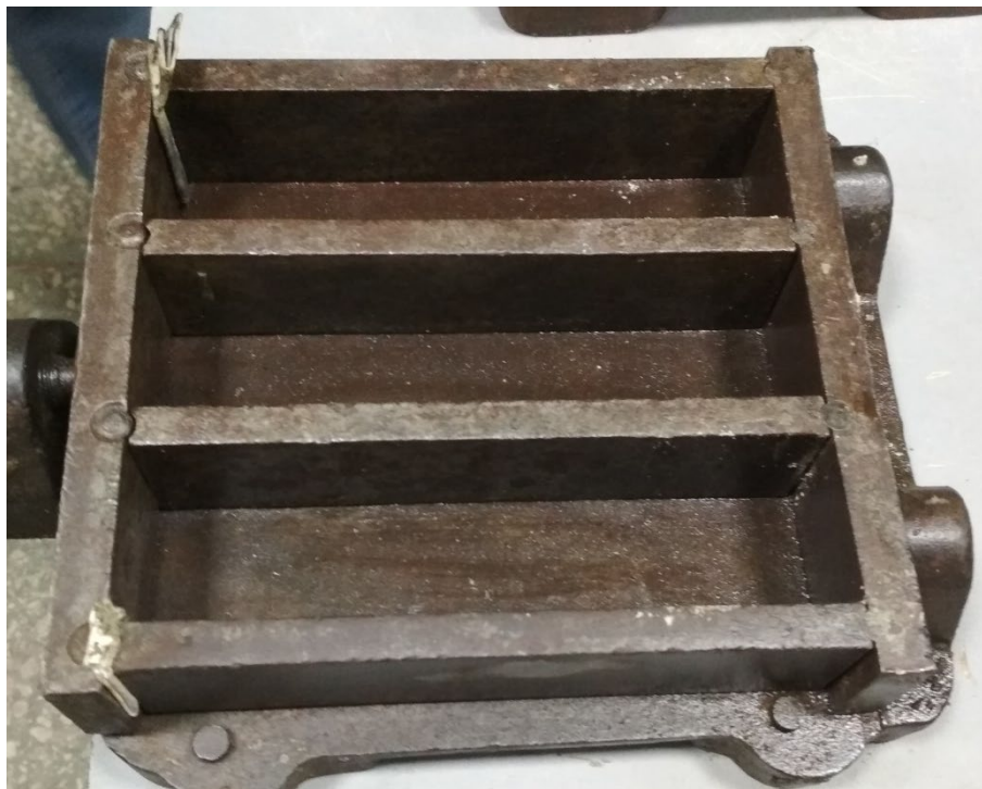
Рис. 3.3. Форма для виготовлення цементних зразків
