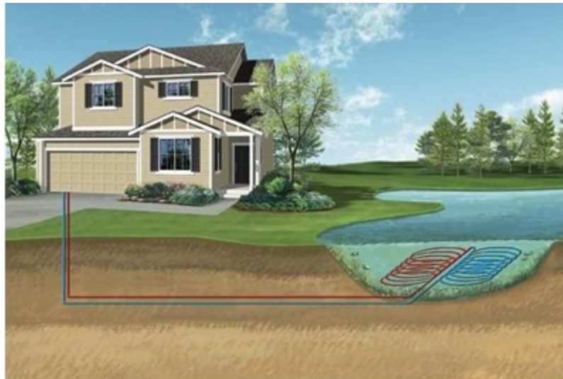
Рис. 1.4. Геотермальний тепловий насос з притопленим контуром
