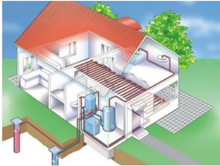
Рис. 1.5. Тепловий насос з використанням ґрунтових вод
