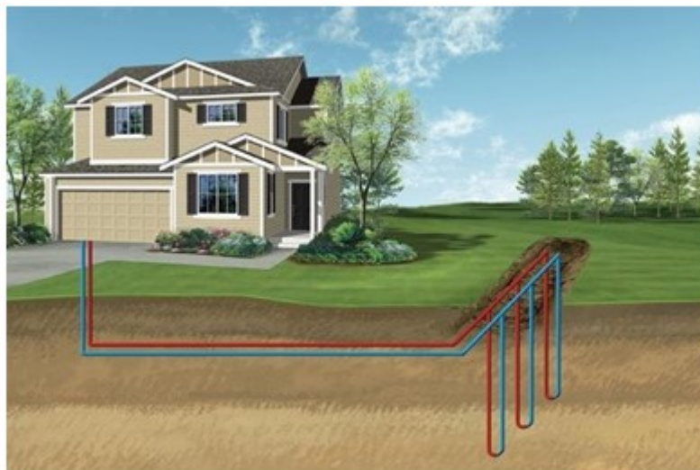
Рис. 1.3. Геотермальний тепловий насос з вертикальним контуром
