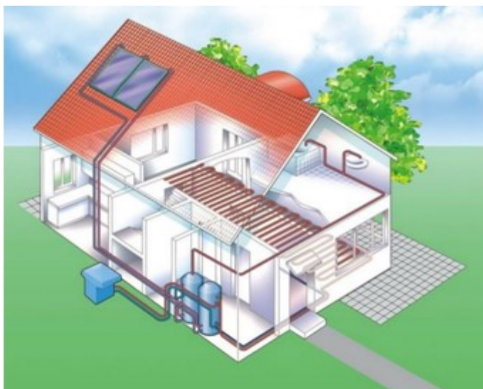
Рис. 1.6. Повітряний тепловий насос
