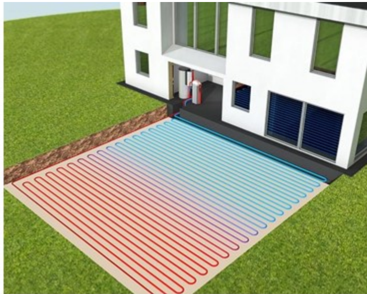
Рис. 1.2. Геотермальний тепловий насос з горизонтальним контуром
