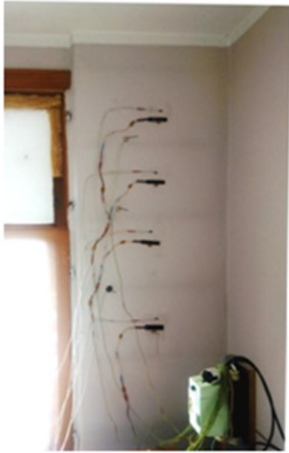
Рис. 1.9. Оцінка ефективності утеплення стіни з внутрішньої сторони пінополістиролом
