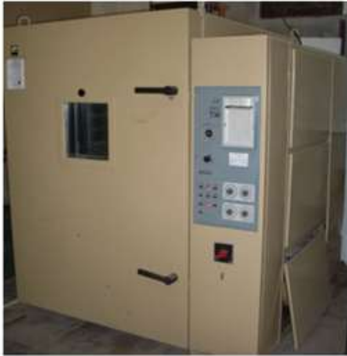
Рис. 1.13. Кліматична камера для проведення циклічних кліматичних випробувань
