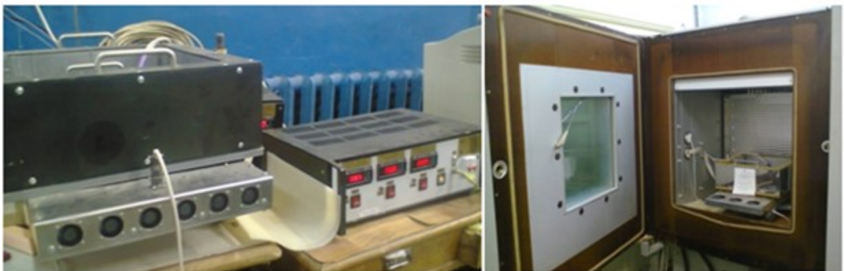
Рис. 1.14. Установки для визначення теплопровідності
