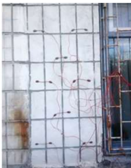
Рис. 1.12. Місця кріплення термопар під піносклом
