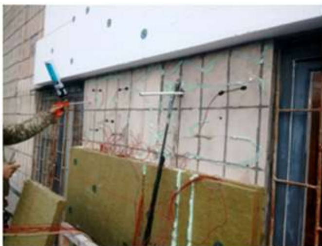
Рис. 1.11. Місця кріплення термопар під мінеральною ватою
