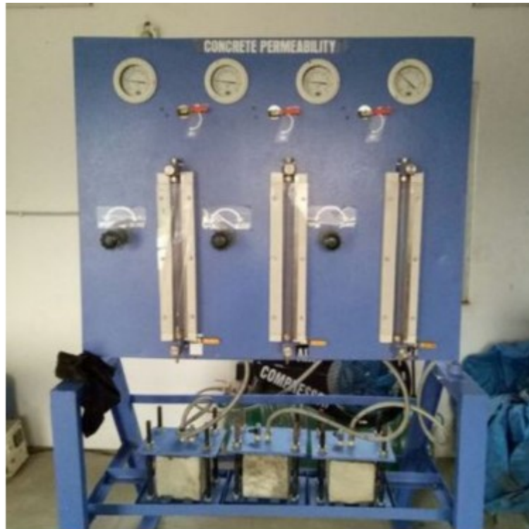
Рис. 1.3. Випробування на водонепроникність бетону
