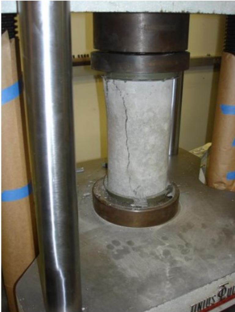
Рис. 1.2. Випробування міцності на стиск
