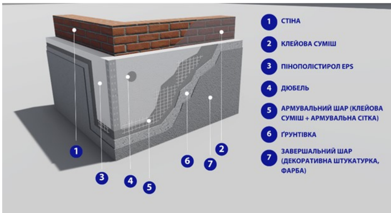
Рис. 1.2. Схема з'єднання утеплювача
