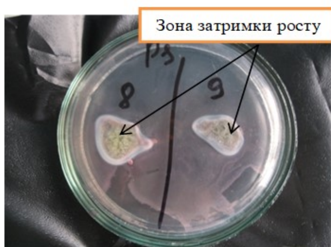
Рис. 1.7. Зона затримки росту культури Pseudomonas aeruginosa навколо зразків бетону з добавкою
