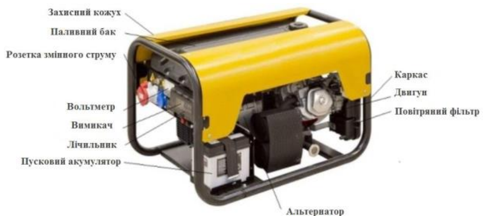
Рисунок 1.3 – Загальна будова дизельного генератора
