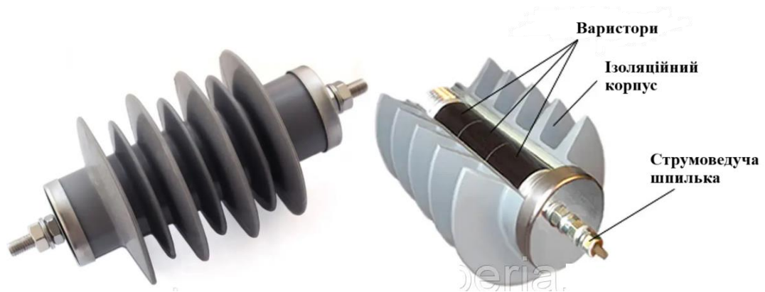
Рис.2.1. Будова нелінійного обмежувача перенапруг (ОПН)
