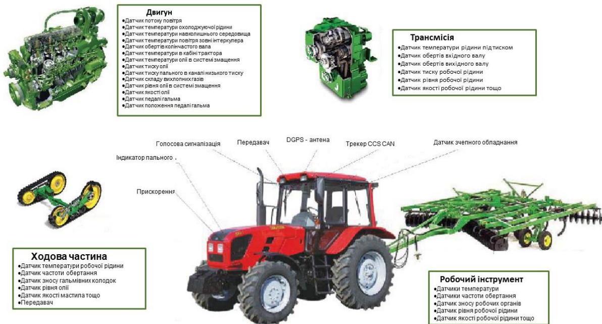
Рисунок 3.1: Схема розподілу датчиків в силових агрегатах машини
