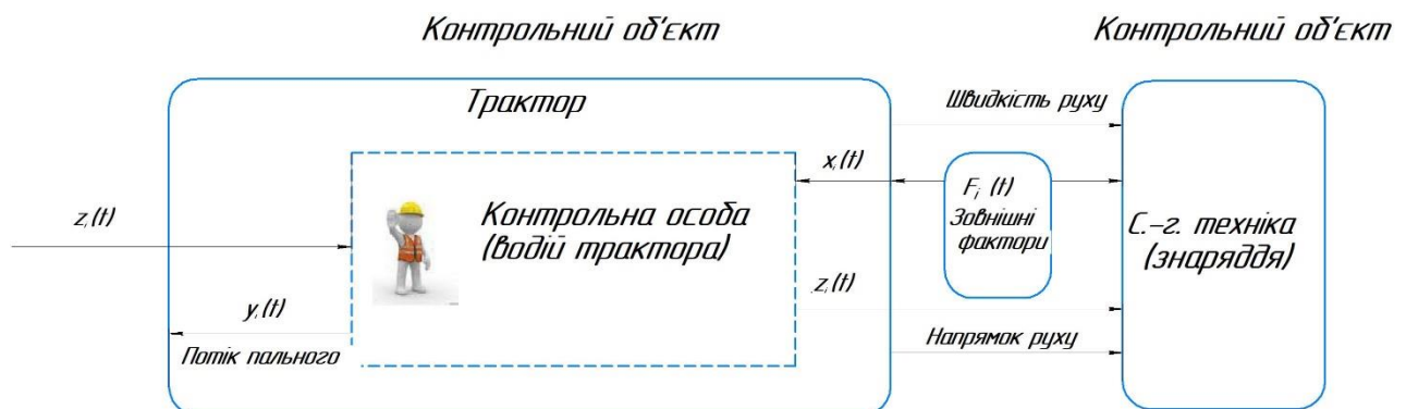
Рисунок 3.3. - Існуюча схема керування роботою машинно-тракторного агрегату
