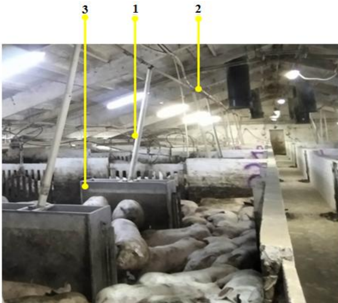
Рис. 2.11. Система подачі сухого корму на відгодівлі для свиней першої (контрольної) групи в першому досліді другого етапу досліджень (фото автора) 1 – спуск, 2 – ланцюгово-шайбовий транспортер, 3 – кормовий автомат
