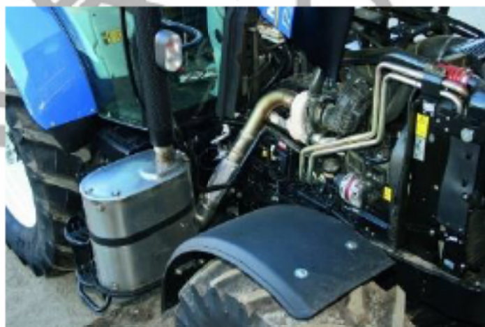
Рисунок 3.2 – Розміщення водяного насоса в тракторі New Holland T7060
