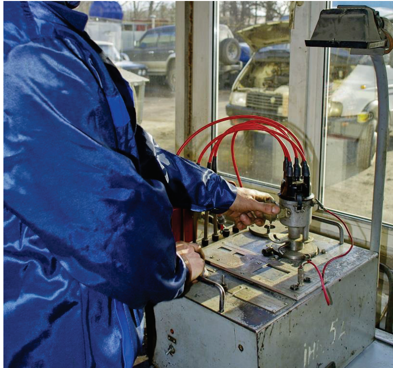
Рисунок 3.2 - Перевірка на стенді та ремонт переривника-розподільника Перевірка контактів переривника на стенді наступна.
