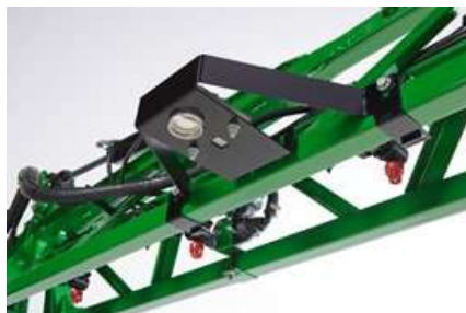
Рис.2.15. Ультрафіолетовий датчик висоти штанги Boom Track.
