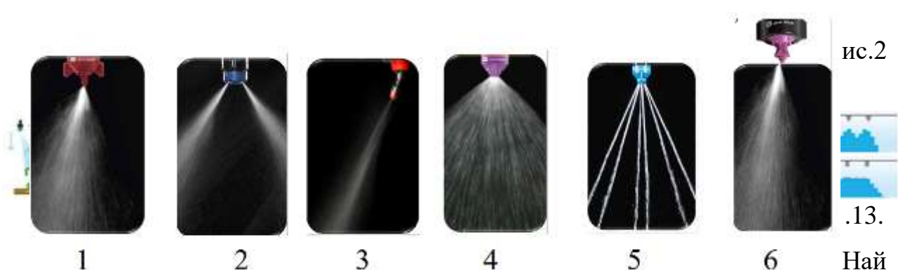
Рис.2.12. Види наконечників та їх робота.
