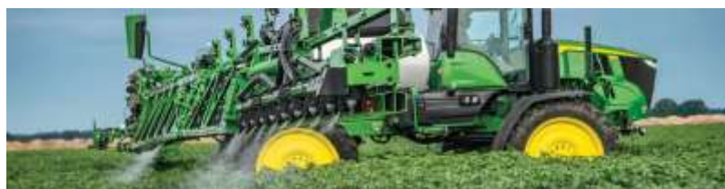
Рис.2.16. Система пофорсуночного вимкнення обприскування Exact Apply
