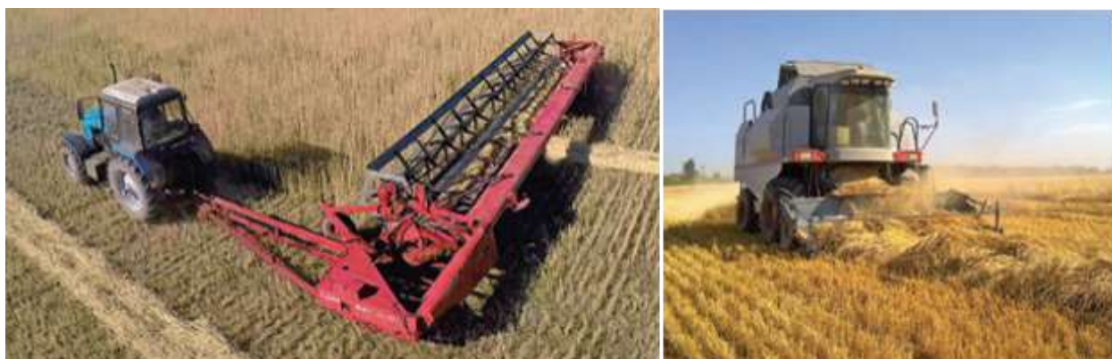
Рис. 2.1.4 Перша та друга фази роздільного комбайнування.
