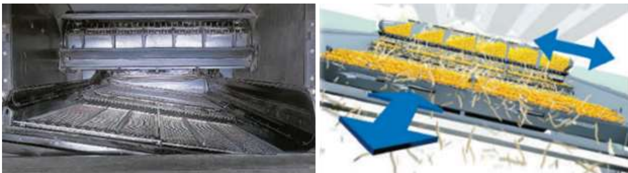
Рис. 2.2.9 Системи очистки компенсацією поперечного нахилу комбайна від New Holland та Claas
