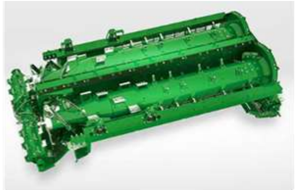
Рис. 3.1. Комбайн John Deere X9 та МСП даної машини
