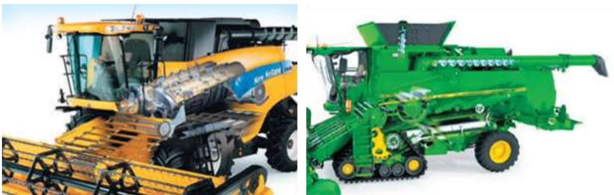
Рис. 2.2.2 Двороторний комбайн від New Holland та клявішний комбайн від John Deere
