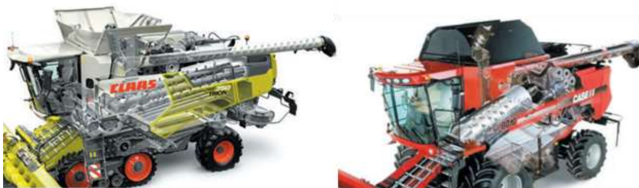
Рис. 2.2.1 Гібридний комбайн від Claas та роторний комбайн від Case-IH
