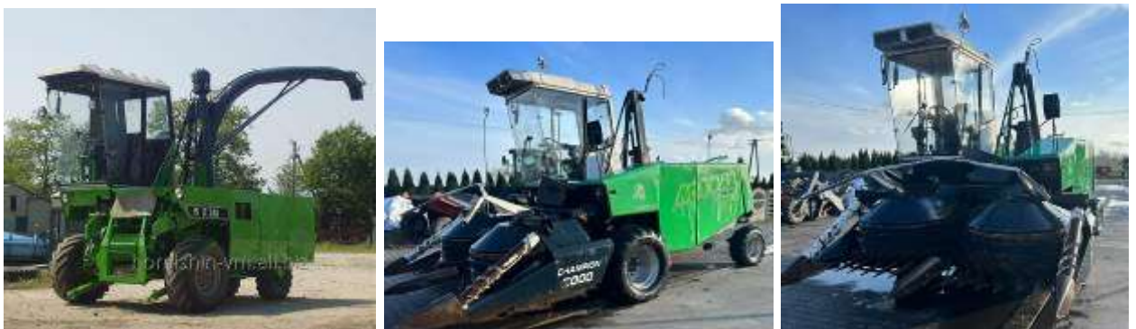
Рис. 2.15. Комбайн для збирання кукурудзи на силос з жаткою
