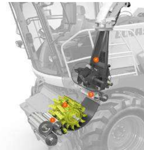
Рис. 2.3. Комбайн та його подрібнювальний апарат. Джерело [10]:
