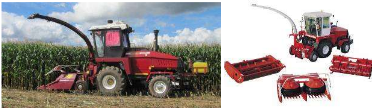
Рис. 2.17. Енергетичний засіб та комплект полу причіпного обладнання для заготівлі кормів
