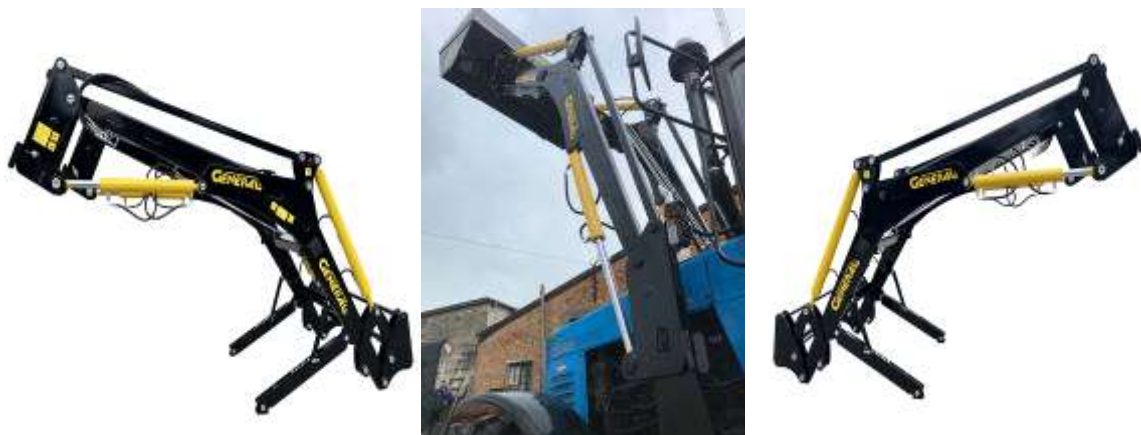
Рис. 3.3. Навантажувач (фронтальний) КУН «General» модель XL
