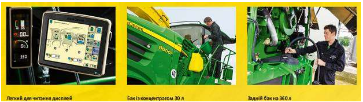
Рис. 2.14. Система для внесення консервантів у кормозбиральних комбайнах
