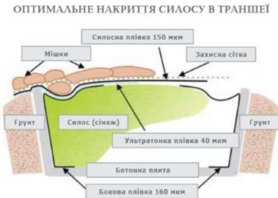
Рис. 2.2. Технологічна схема зберігання силосу в траншеях.
