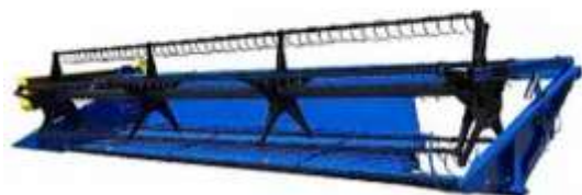
Рис. 2.8. Причіпні та навісні жатки для скошування рослинної маси.
