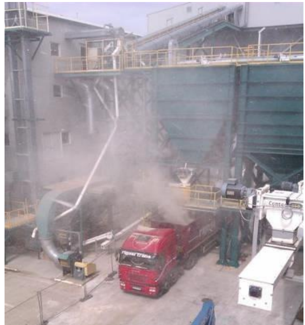
Рисунок 4.2. Виділення пилу в процесі завантаження відкритого транспорту.
