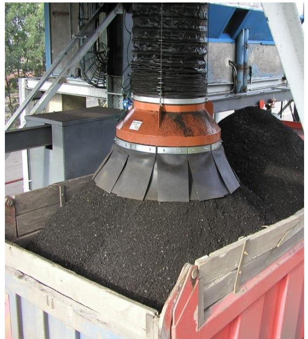
Рисунок 4.4. Приклад встановлення телескопічного аспіраційного рукаву
