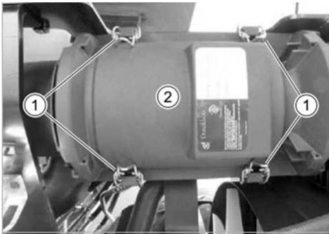
Рис. 3.5. Зняття та встановлення повітряного фільтра двигуна.
