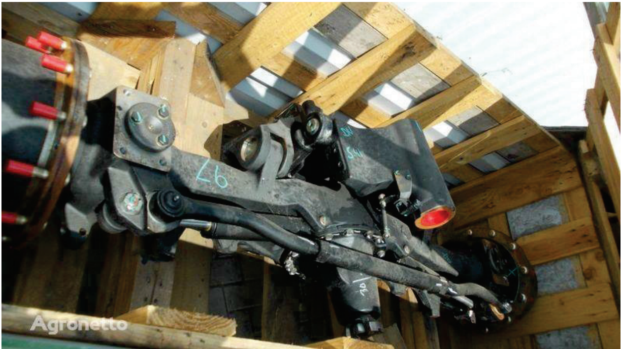
Рисунок 1.3 – Передній ведучий міст трактора New Holland T8040 [9].
