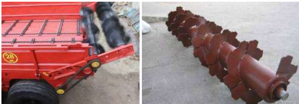
Рис. 3.1. Конструкція розкидача органічних добрив
