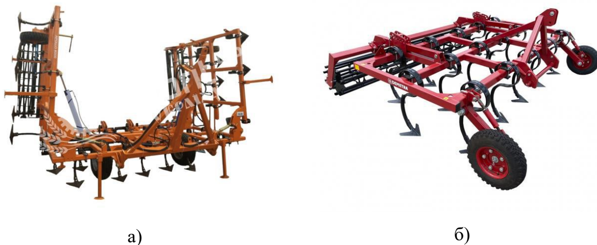
Рисунок 1.6 – Комбіновані культиватори суцільного обробітку: а – КПФ 8000 APOLLO; б – КСО-3Н
