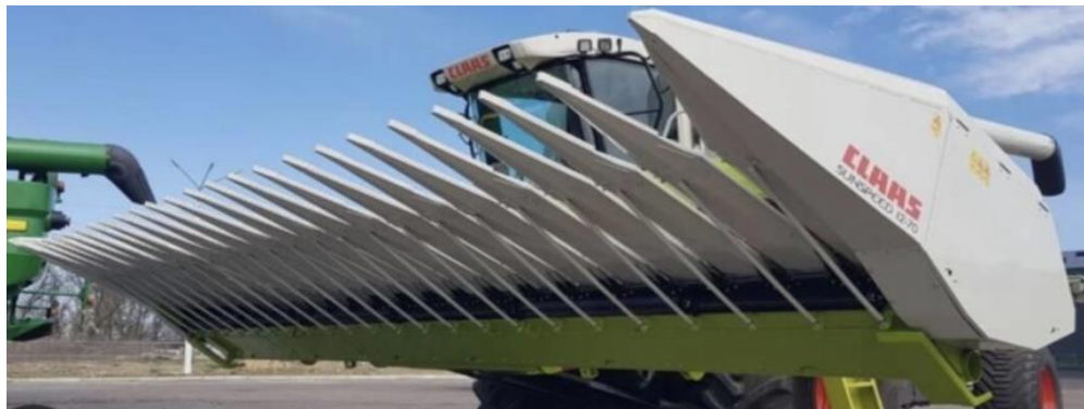
Рисунок 1.11 – Загальний вигляд спецжатки для збирання соняшника SUNSPEED 12-70 від CLAAS
