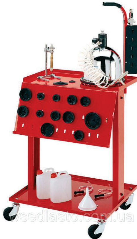
Рисунок 3.5 - Установка для прокачування гальм і зчеплень, в тому числі з ABS Omprі 51100.
