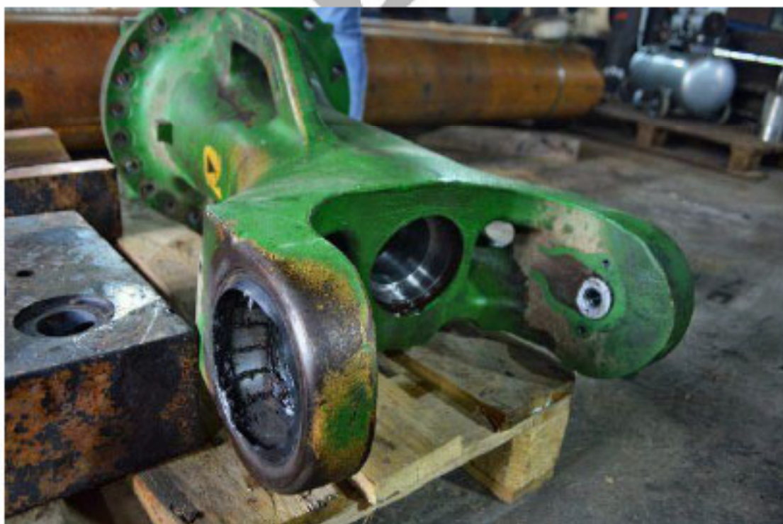
Рисунок 3.1. – Зношений корпус напіввісі переднього мосту трактора Джон Дір 83000
