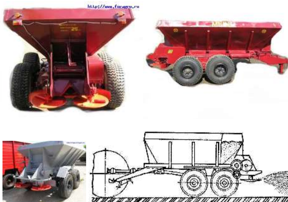
Рис. 3.2. Машина для внесення добрив МВУ – 8
