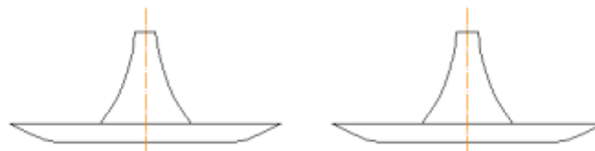
Рис. 3.6. Експериментальний відцентровий робочий орган у вигляді псевдосфери.
