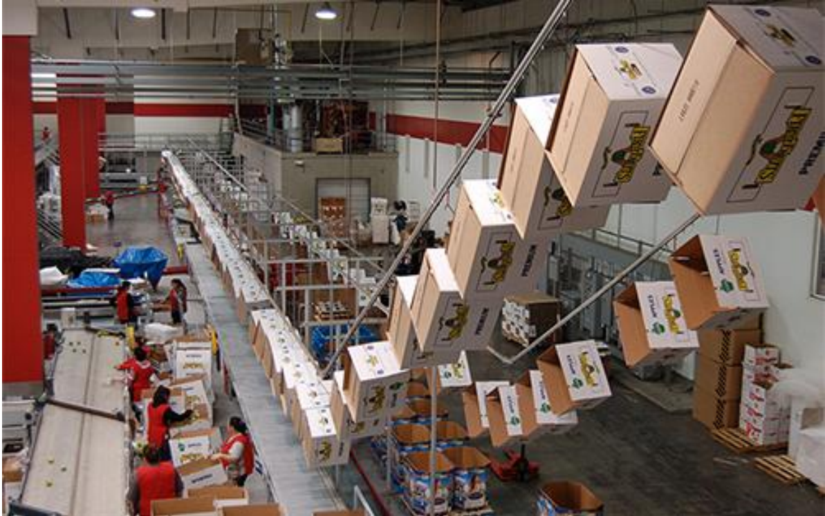
Рисунок 2.7 – Закритий підвісний конвеєр [13]
