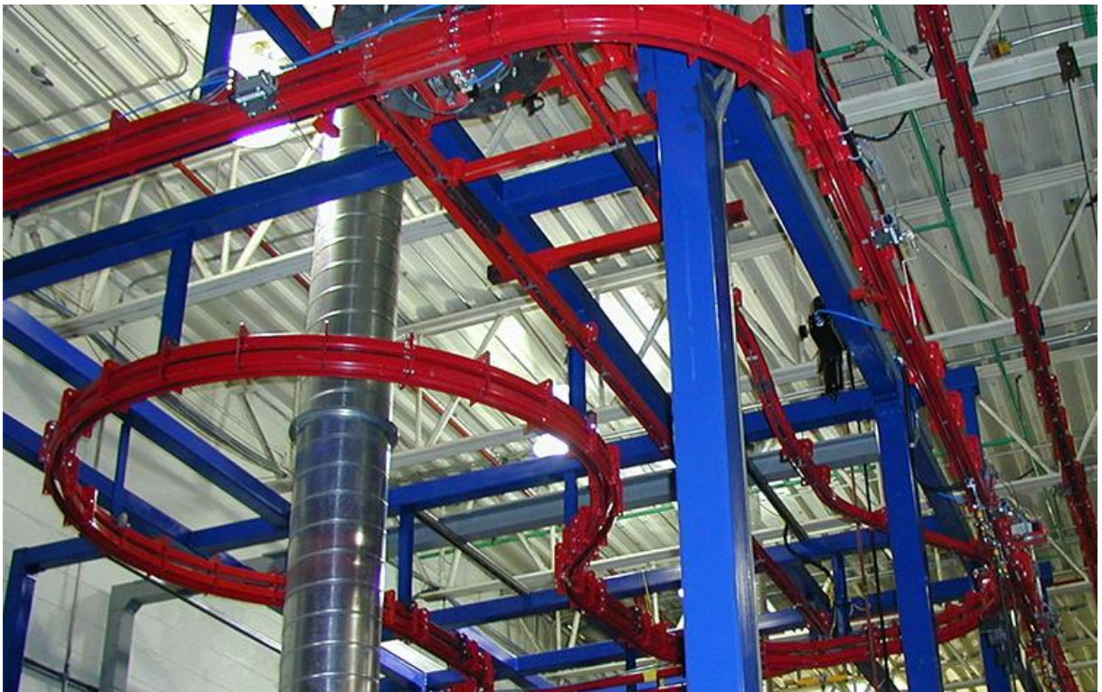
Рисунок 2.6 – Підвісний конвеєр з живленням та безперервним рухом [13]
