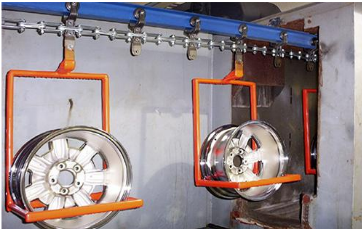
Рисунок 2.5 – Підвісні конвеєри з І-подібною балкою [13]
