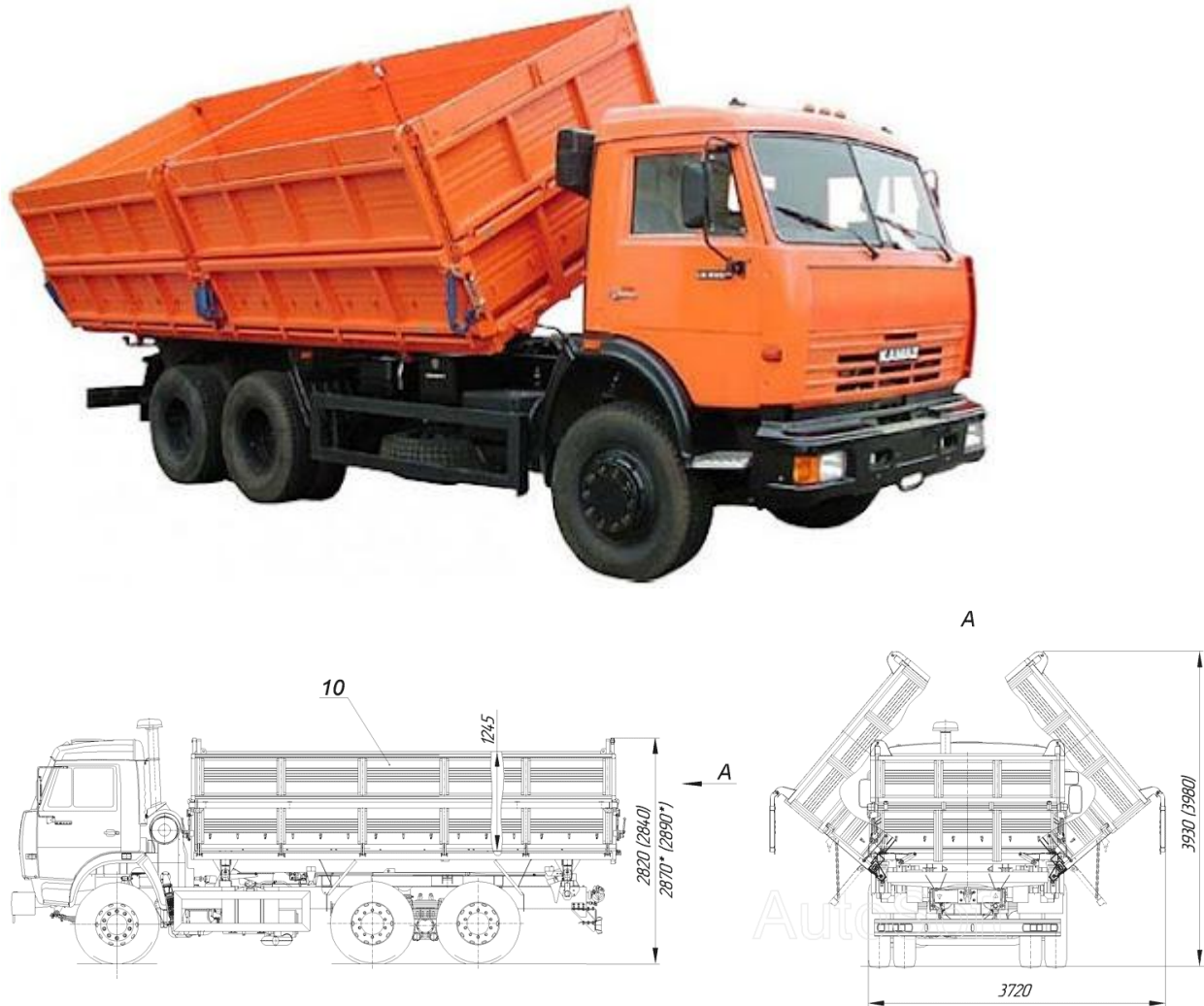
Рис. 1 Загальний вигляд і схема бортового автомобіля КамАЗ 45143
