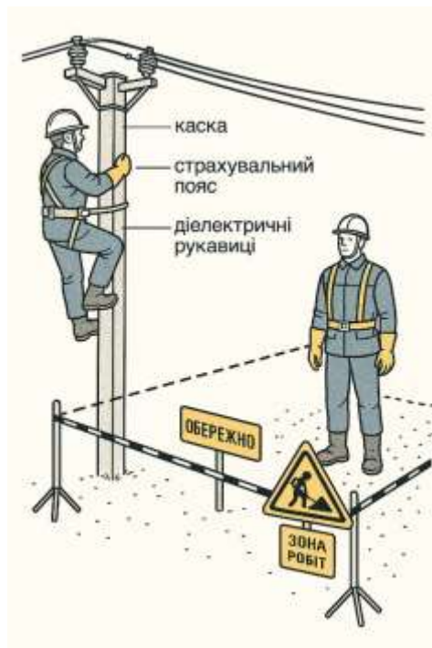
Рисунок 4.8 - Техніка безпеки під час монтажу ОЛ-0,4 кВ із СІП.
