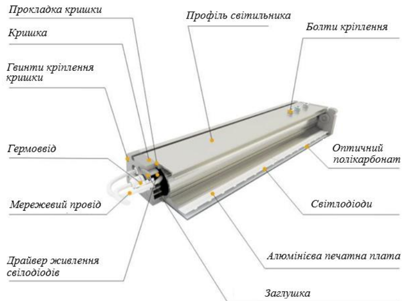
Рисунок 2.6 – Влаштування світлодіодного світильника
