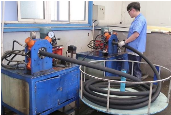
Рисунок 2.2 – Процес обтискання рукава високого тиску на пресі
