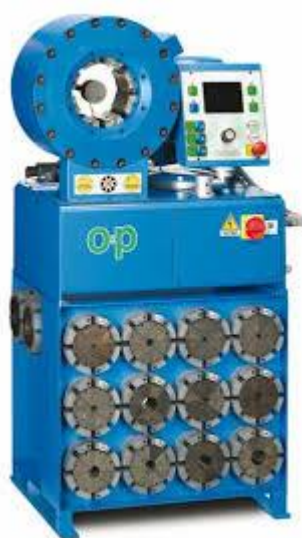
Рисунок 2.1 – Загальний вигляд пресу для опресування шланг та рукавів високого тиску
