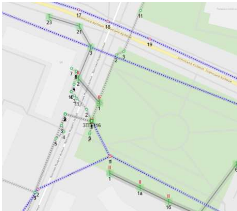
Рис. 1.1. Ситуаційна схема системи електропостачання від ЗТП116
