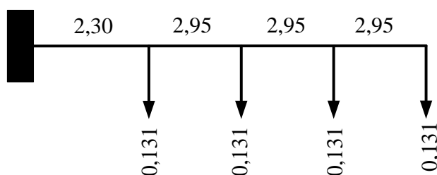
Рисунок 4.3 –схема групової лінії №1
