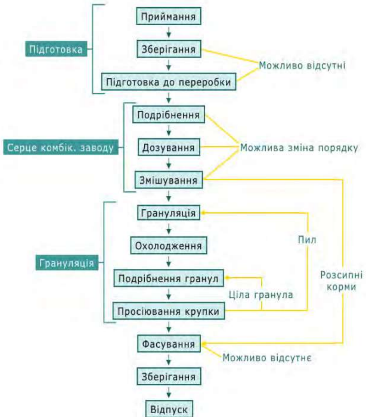
Рисунок 2.1- Послідовність виконання операцій при виробництві комбікормів
