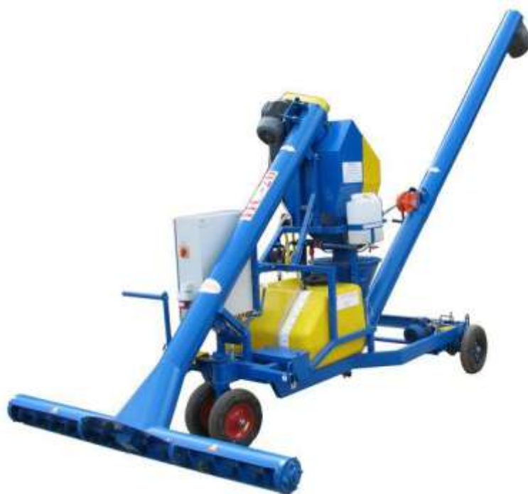
Рис. 4.1. Зовнішній облік конструкції протруювального апарату ПС-20
