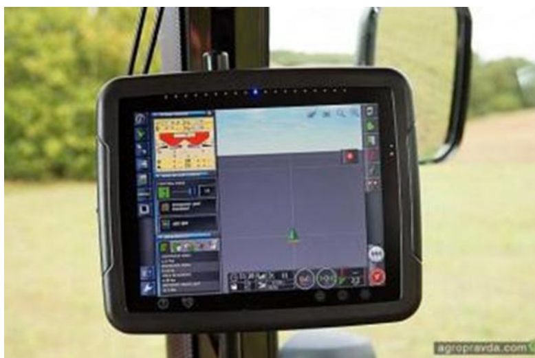
Рисунок 2.6 – AGCO Fuse - система телеметрії та документування [24].
