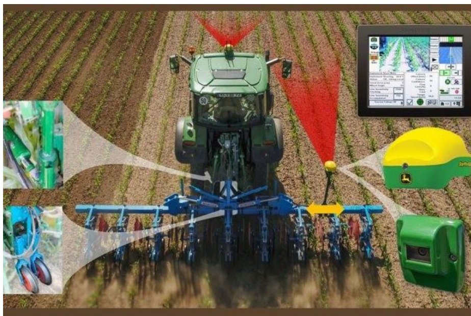
Рисунок 2.5 – Автоматичне керування – система AutoTrac[23].-
