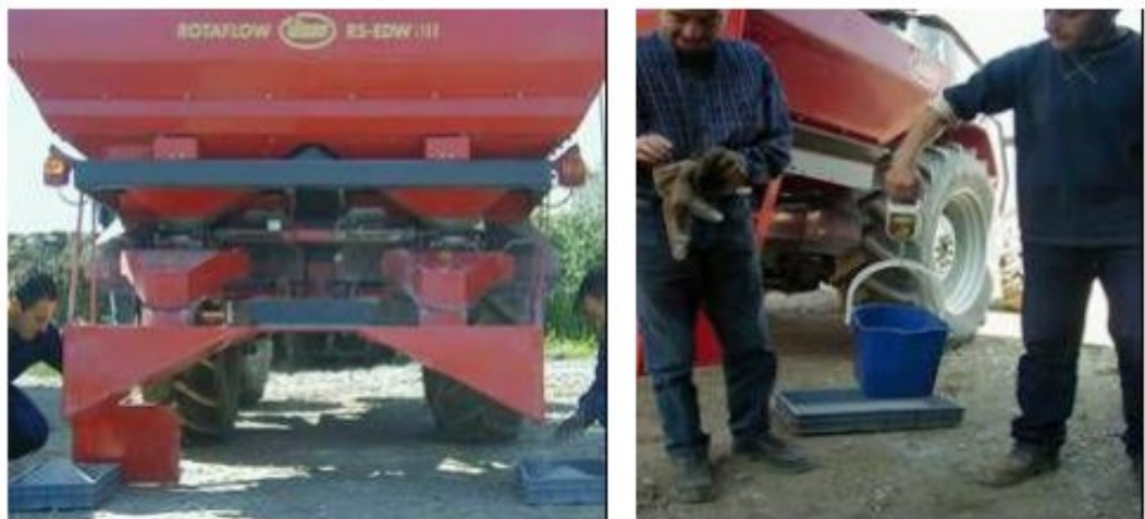
Рис. 3 - Польові тестування для калібрування відцентрового розкидача добрив Vicon RS-EDW
