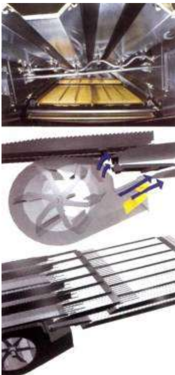
Рис. 1.16 Очистка комбайнів NEW HOLLAND CX і CR
