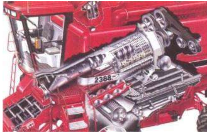
Рис. 1.11 МСП комбайнів серії AF 2388 і AFX 8010 від CASE IH.
