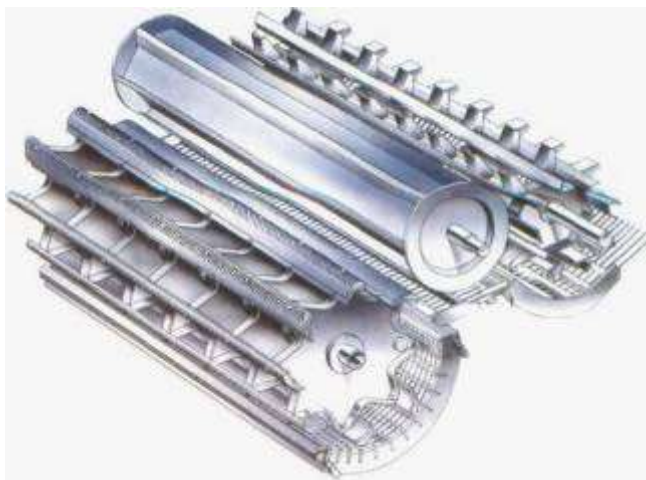
Рис. 1.3. МСП комбайнів MASSEY FERGUSON CEREА
