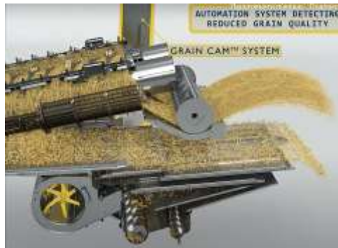
Рис. 2.5. Комбайн New Holland CR Revelation з автоматизованою системою збирання IntelliSense та камерою Grain Cam.
