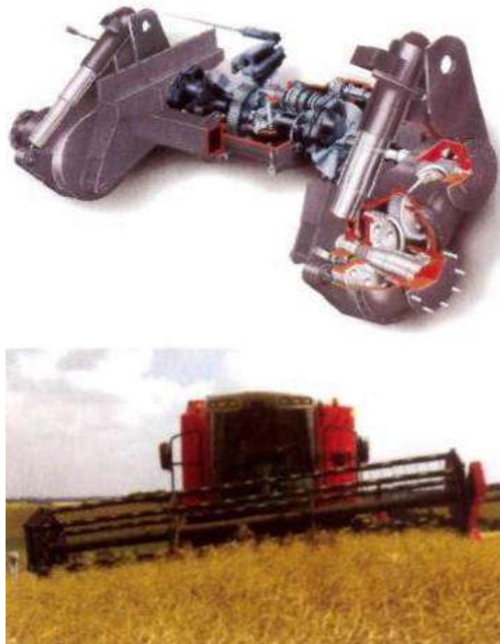
Рис. 1.19 AVTOLEVEL система для вирівнювання молотарки
