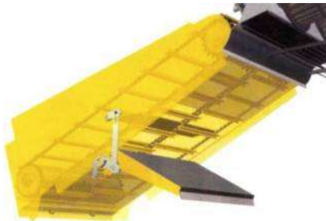
Рис. 1.10 Проти попадання сторонніх об'єктів в молотильно-сепаруючий пристрій (МСП) комбайнів серії CR.
