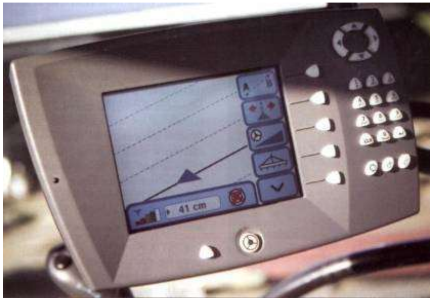
Рис. 1.22 Система автоматичного водіння "Autoguide" від AGCO, розроблена для тракторів Challenger MT 700
