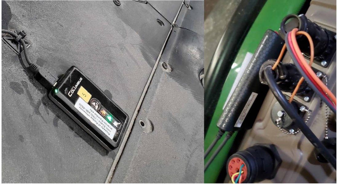
Рисунок 1.1 - зліва зображений логер Columbus V990, справа — Kvaser Memorator Pro 2xHS GPS Logger.
