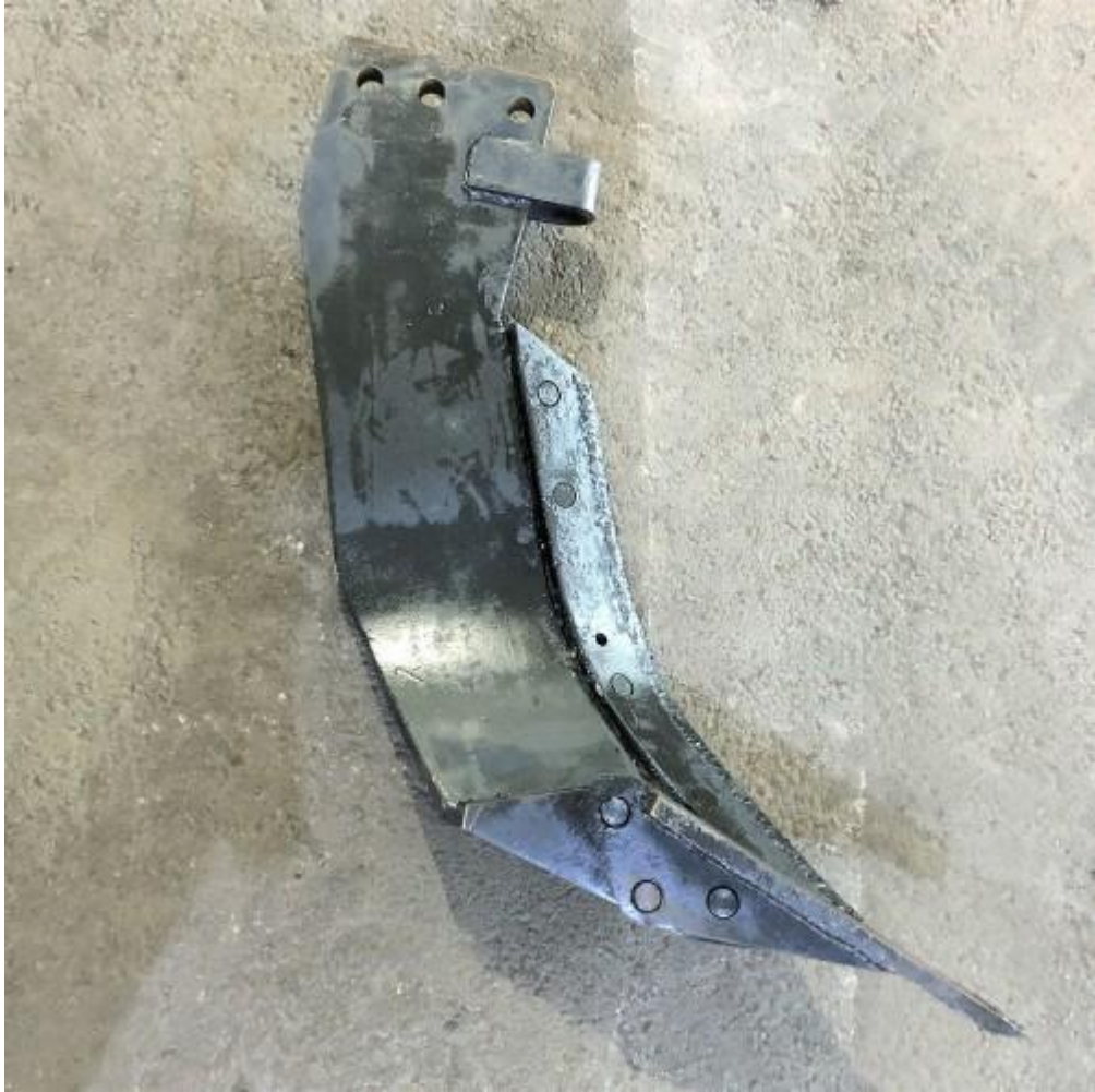
Рисунок 1.9 - Саморобний робочий орган типу Paraplow
