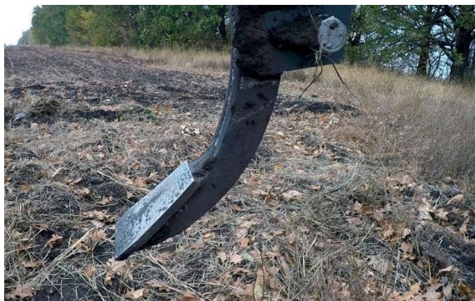
Рисунок 3.2- Загальний вигляд дослідного зразка глибокорозпушувача
