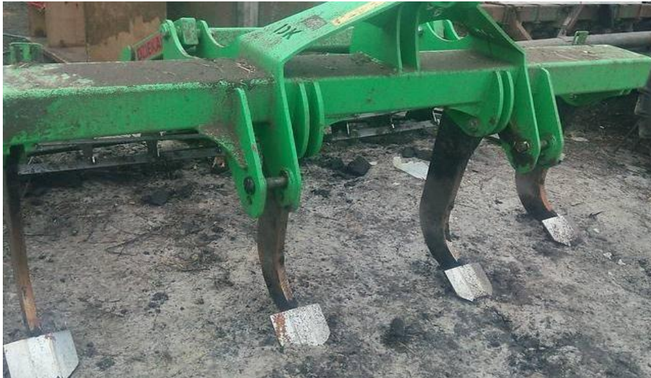
Рисунок 1.8 – Агрегат для глибокого розпушування із лопатовидними робочими органами
