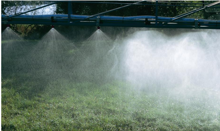
Рисунок 1.5 - Інжекторні та щілинні розпилювачі (ліворуч та праворуч відповідно)
