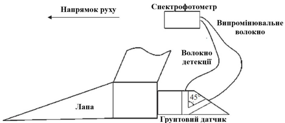
Рис. 1 – Схематична діаграма видимого та ближнього інфрачервоного (VIS–NIR) датчика ґрунту
