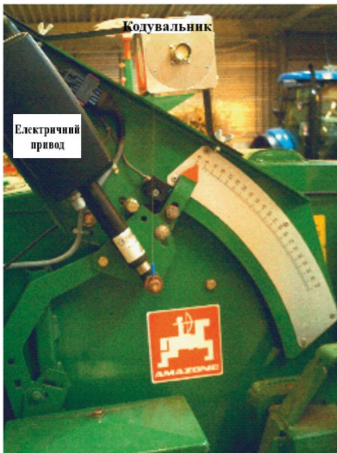
Рис. 2 – Електричний привод для зміни норми внесення (ED 302, AMAZONE) і кодер для вимірювання переміщення приводу
