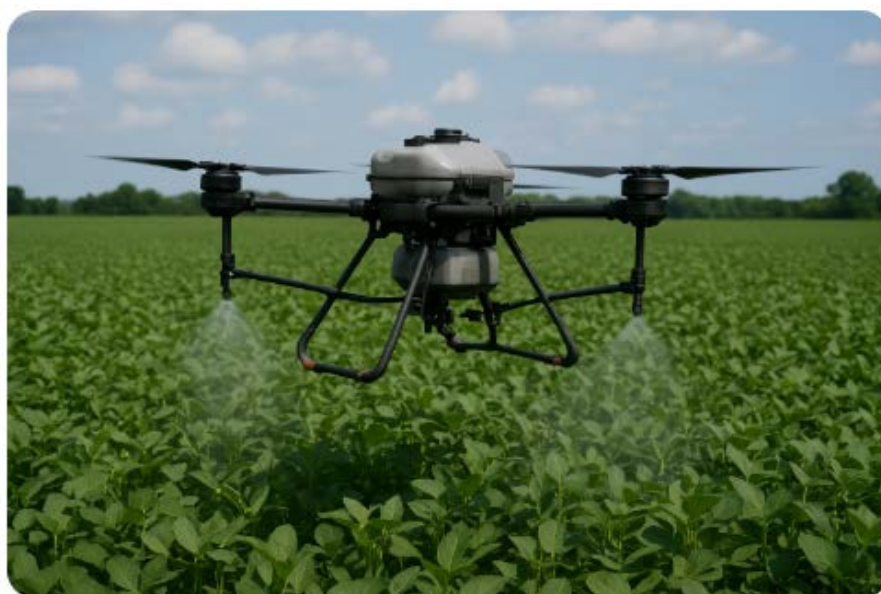
Рисунок 3.9 –Загальний вид дрона DJI Agras T30 під час обприскування сої (вид зі сторони; демонстрація ширини смуги).
