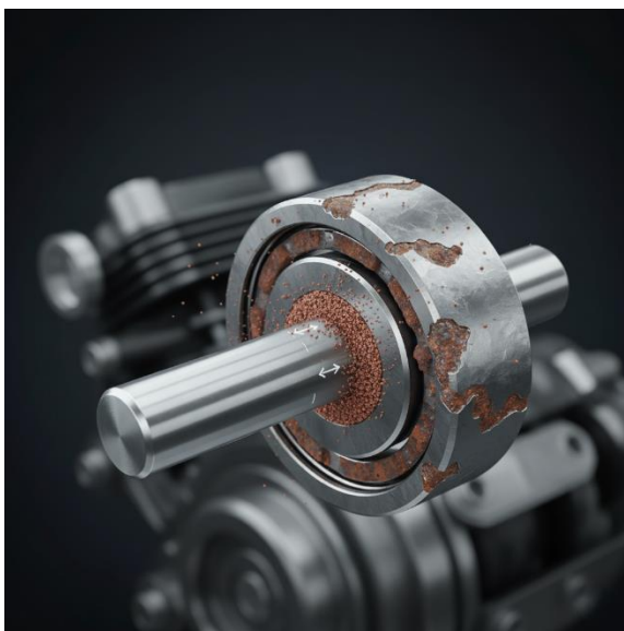
Рис. 1.11 - Зношування внаслідок фреттинг-корозії [7]
