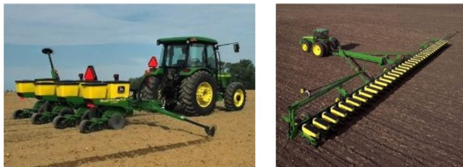
Рис. 1 - Розмір сівалки для просапних культур від (а) 4 сошників до (б) 56 сошників
