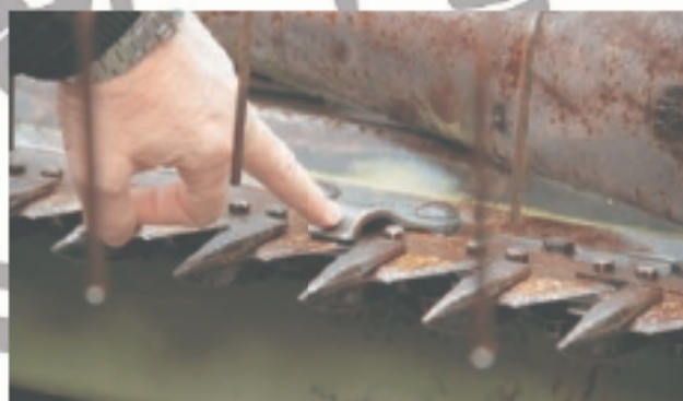
Рисунок 1.7 – Приклад пошкоджених корозією деталей ріжучого апарату
