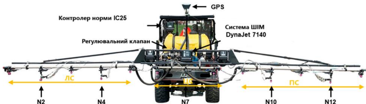
Рис. 1 - Налаштування обприскувача та різні компоненти, що використовуються для тестування ефективності розпилення. ЛС, ЦС та ПС позначають ліву, центральну та праву секції штанги відповідно, тоді як форсунки пронумеровані від N1 до N13, починаючи зліва від штанги обприскувача.
