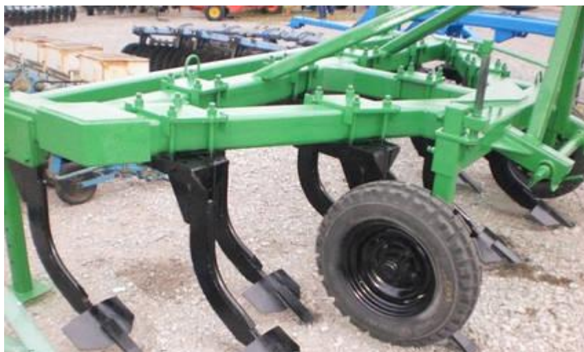
Рисунок 2.2 - плуг чизельний ПЧ-4,5
