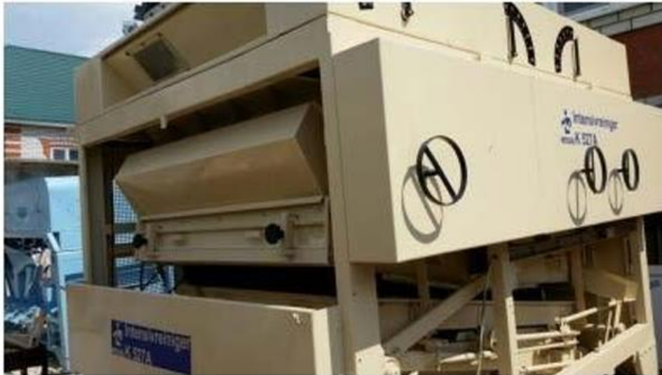
Рисунок 1.2 – Апарат для очистки зерна K527A «Петкус»
